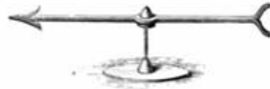
XII. ábra. Gilbert Versoriuma – Egy forgótengegyre erősített korai elektromosságmérő féműből készítve.
