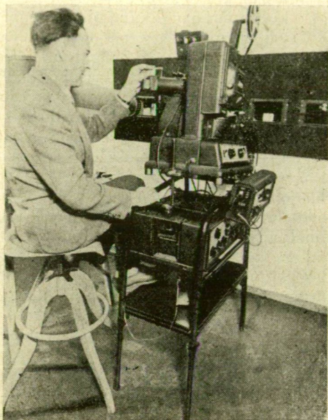
7. ábra. 16 mm-es keskenyfilm vetítógép, fényhangra és mágneshangra is alkalmas (Leitz G 1, Telefunken hang)
